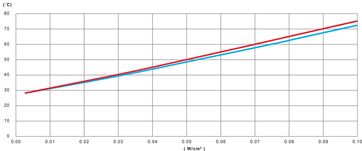
Variación, en función de la potencia en  $W/cm^2$  de la cinta calefactora de silicona, de la temperatura de la pared de un tubo de PVC vacío, aislado térmicamente con 20 mm de espuma de PVC-NBR
