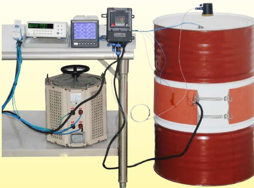
Variación de la temperatura versus el tiempo de un tambor de metal de 220 litros, **lleno de agua**, calentado por una cinta calefactora de silicona de 200 mm de ancho, sin aislamiento térmico, potencia de **2250 W** (carga de potencia superficial de **0,75 W/cm²**).
