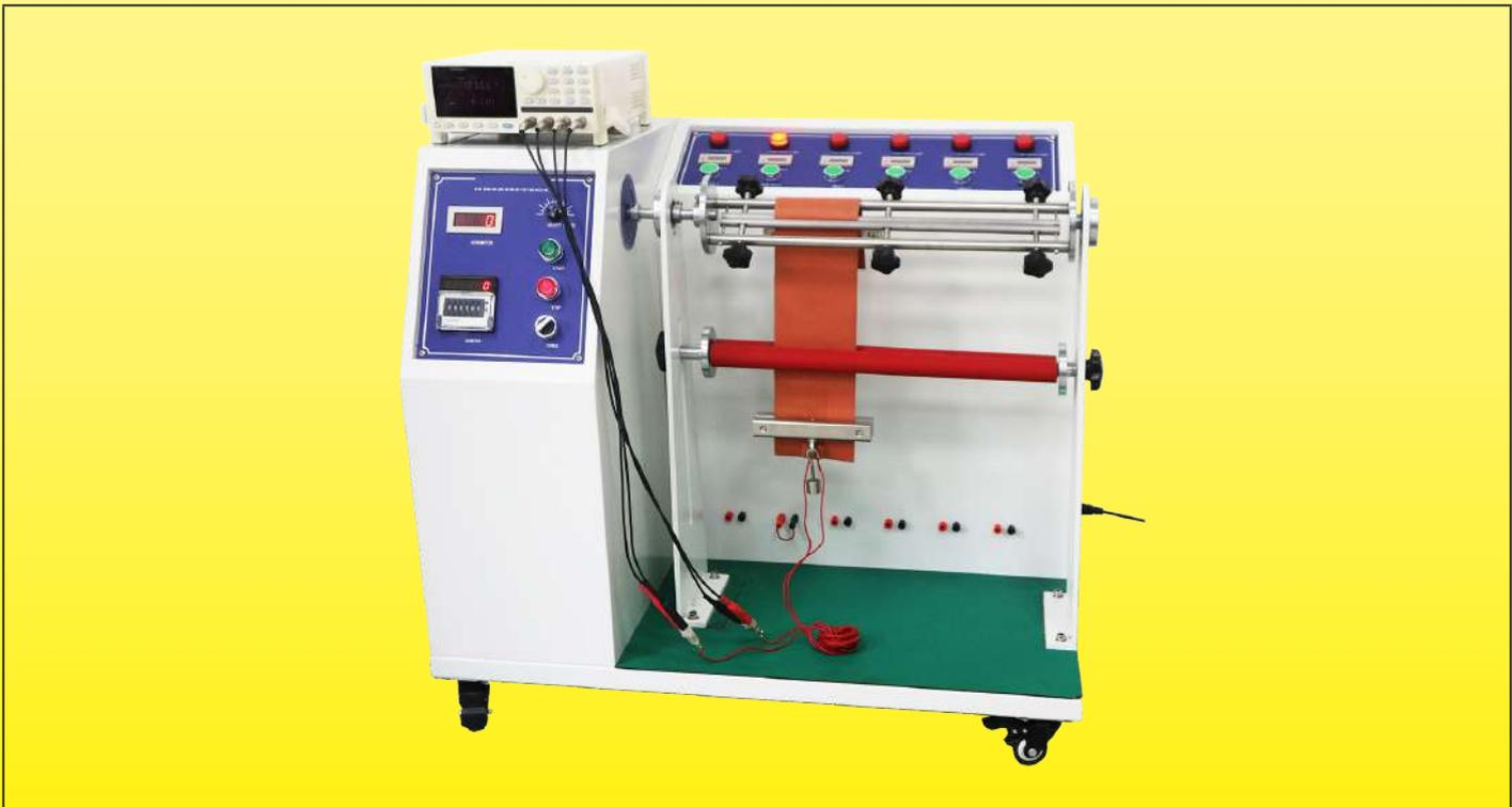
Calentador de silicona flexible durante la prueba de flexión
