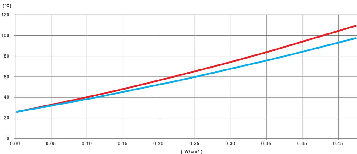
Variación, en función de la potencia en  $W/cm^2$  de la cinta calefactora de silicona, de la temperatura de la pared de un tubo de acero inoxidable lleno de agua no circulante, aislado térmicamente con 20 mm de espuma de PVC-NBR
