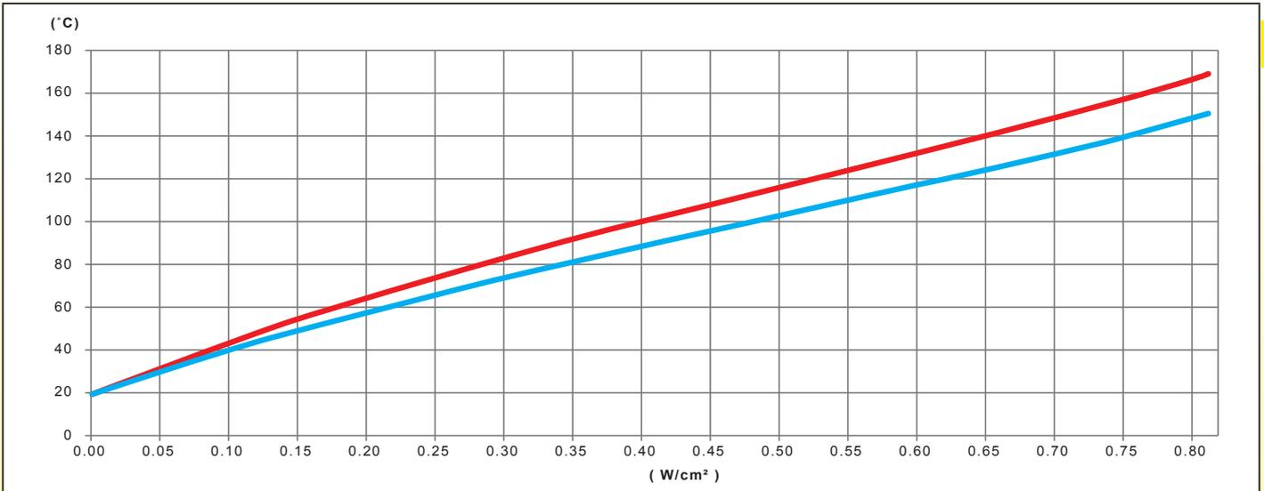
Variación, en función de la potencia en W/cm<sup>2</sup> de la cinta calefactora de silicona, de la temperatura de la pared de un tubo de acero inoxidable vacío y no aislado térmicamente
