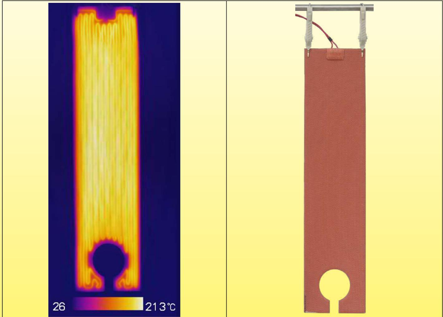
Imagen termográfica de una cinta calefactora de silicona plana de 2,4 mm con una carga de potencia superficial de  $1 W/cm^2$ , suspendida en aire tranquilo, no fijada en una placa, a una temperatura ambiente de  $25\text{ }^\circ\text{C}$ . La temperatura superficial alcanza los  $213\text{ }^\circ\text{C}$ , cerca de su destrucción.
