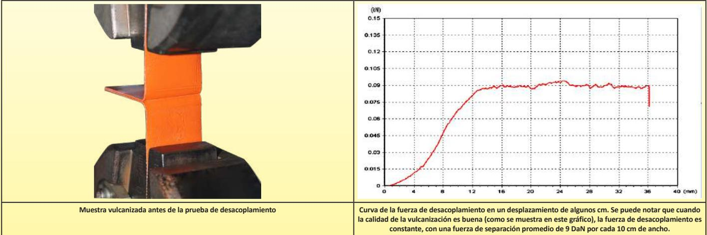
Muestra vulcanizada antes de la prueba de desacoplamiento
