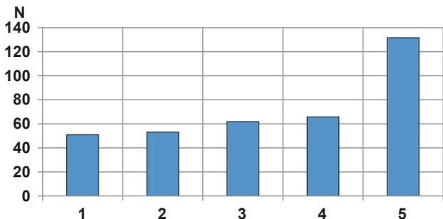
Fuerza comparativa de elongación a 0,05 mm/min de los diferentes modelos de grosores 1: 0,8 mm, 2: 1,6 mm, 3: 2,4 mm, 4: 3,2 mm, 5: 2,4 mm con reforzamiento de malla de acero inoxidable
