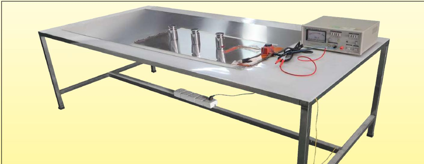
Dispositivo para medir la resistencia de aislamiento.
