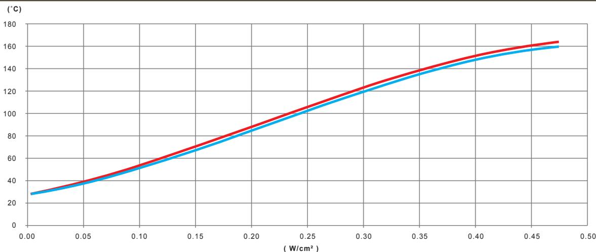
Variación, en función de la potencia en  $W/cm^2$  de la cinta calefactora de silicona, de la temperatura de la pared de un tubo de acero galvanizado vacío, aislado térmicamente con 20 mm de espuma de PVC-NBR
