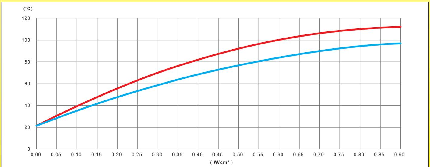
Variación, en función de la potencia en W/cm<sup>2</sup> de la cinta calefactora de silicona, de la temperatura de la pared de un tubo de acero inoxidable lleno de agua no circulante, no aislado térmicamente
