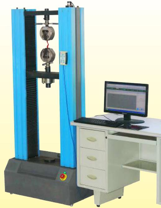
Equipo de prueba de resistencia a la rotura
