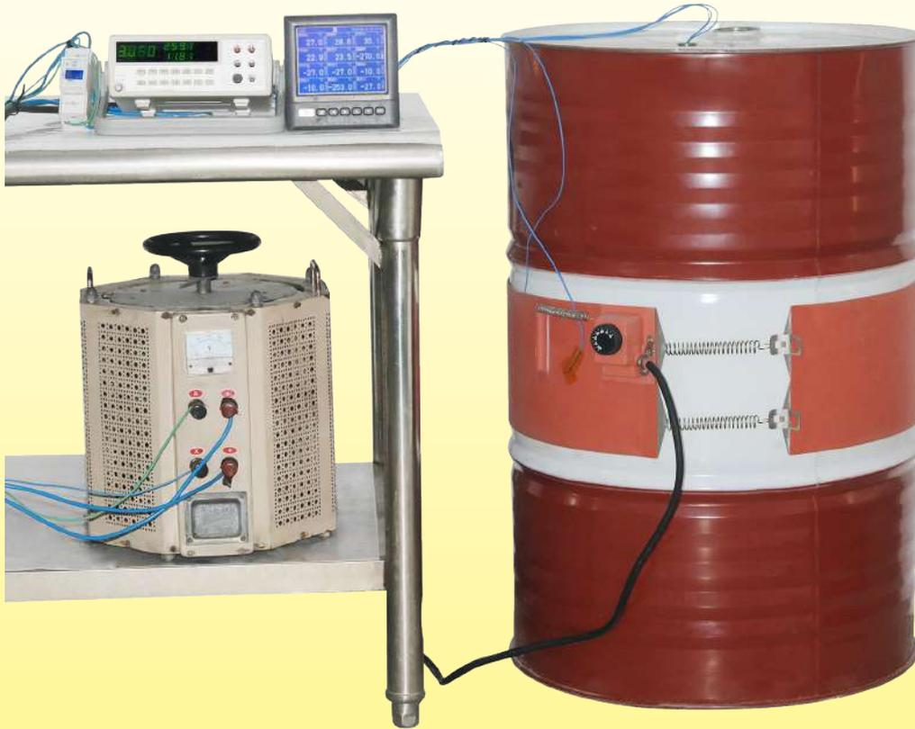
Variación de la temperatura versus el tiempo de un tambor de metal de 220 litros, **lleno de agua**, calentado por una cinta calefactora de silicona de 200 mm de ancho, sin aislamiento térmico, potencia de **2250 W** (carga de potencia superficial de **0,75 W/cm<sup>2</sup>**).
