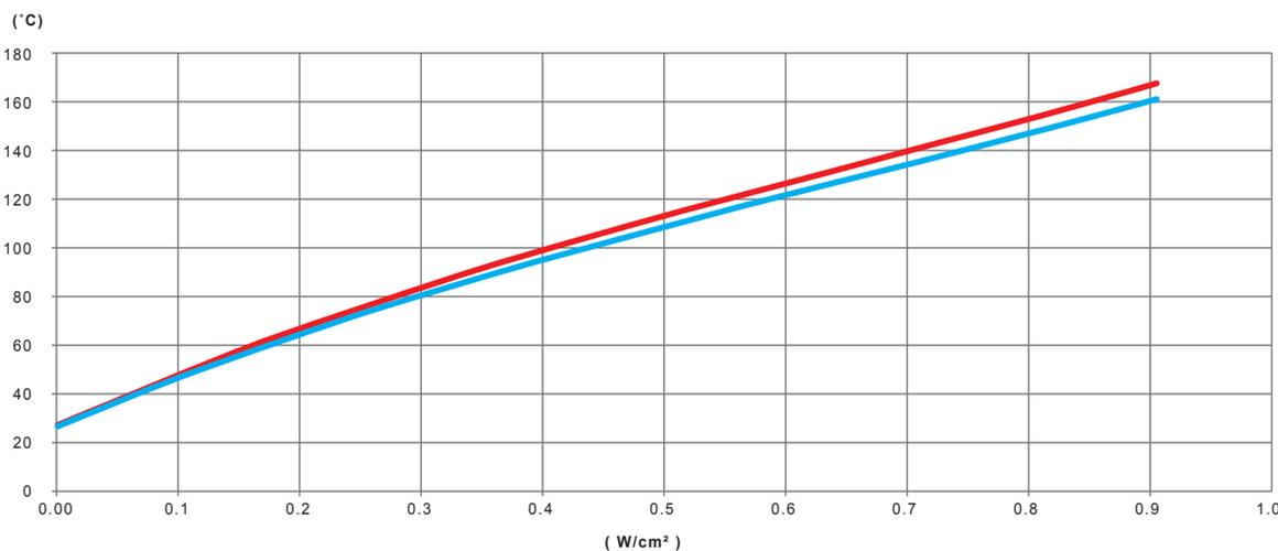
Variación, en función de la potencia en  $W/cm^2$  de la cinta calefactora de silicona, de la temperatura de la pared de un tubo de acero galvanizado vacío y no aislado térmicamente
