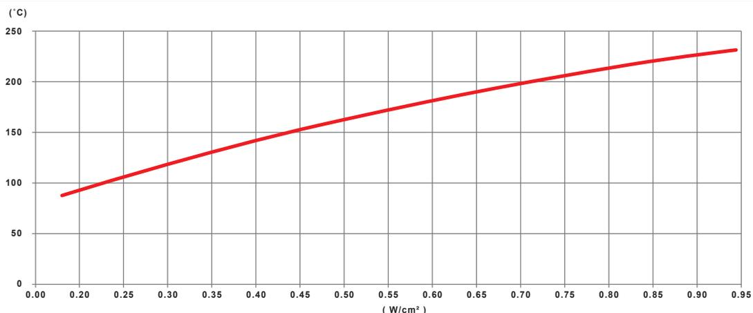
Variación de la temperatura superficial de una cinta calefactora de silicona de 2,5 mm de grosor versus la carga de potencia superficial. La cinta está suspendida en aire tranquilo, no fijada en una superficie de metal, a una temperatura ambiente de  $25\text{ }^\circ\text{C}$ . La cinta no está protegida por un sistema de limitación de temperatura. En estas condiciones, la cinta queda dañada de manera irreversible a  $235\text{ }^\circ\text{C}$ .
