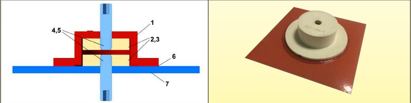
Equipo utilizado para pruebas comparativas (Superficie de unión: 10 cm<sup>2</sup>).
