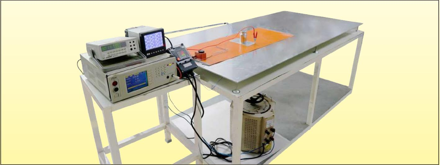
Equipo de medición para la corriente total de fuga en caliente
