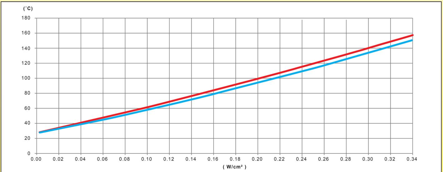
Variación, en función de la potencia en W/cm<sup>2</sup> de la cinta calefactora de silicona, de la temperatura de la pared de un tubo de acero inoxidable vacío, aislado térmicamente con 20 mm de espuma de PVC-NBR
