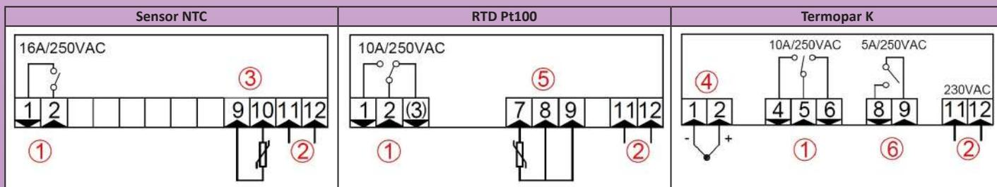
1: Salida del relé; 2: Alimentación 230 V CA; 3: Sensor NTC; 4: Sensor termopar tipo K; 5: Sensor Pt100; 6: Salida del relé de alarma.
